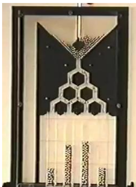
Рис. 9. Демонстрация биномиального распределения при помощи доски Гальтона
