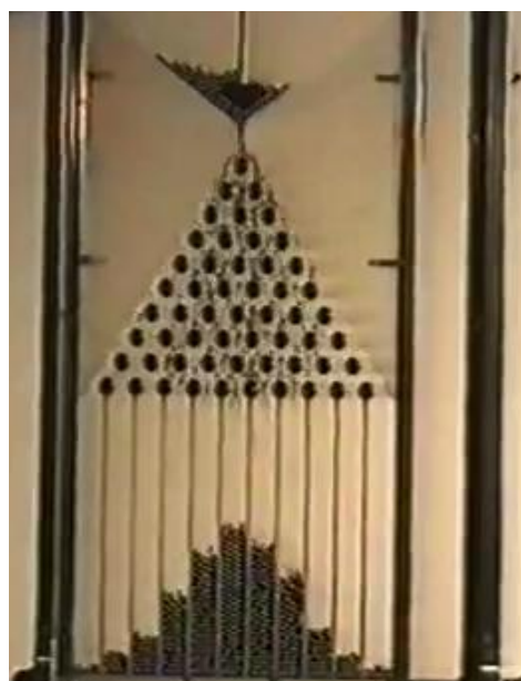
Рис. 10. Демонстрация нормального распределения при помощи доски Гальтона
